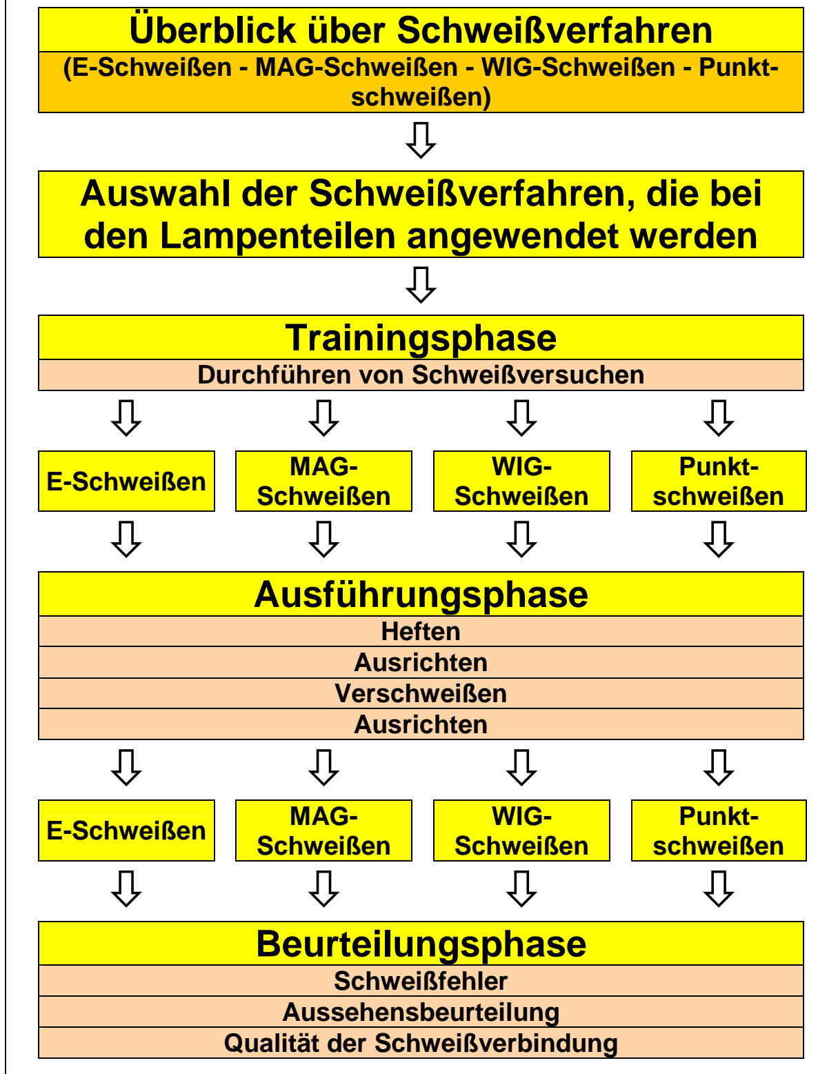
Abb. 127: Mögliches Ablaufschema für die Schweißverfahren 653
