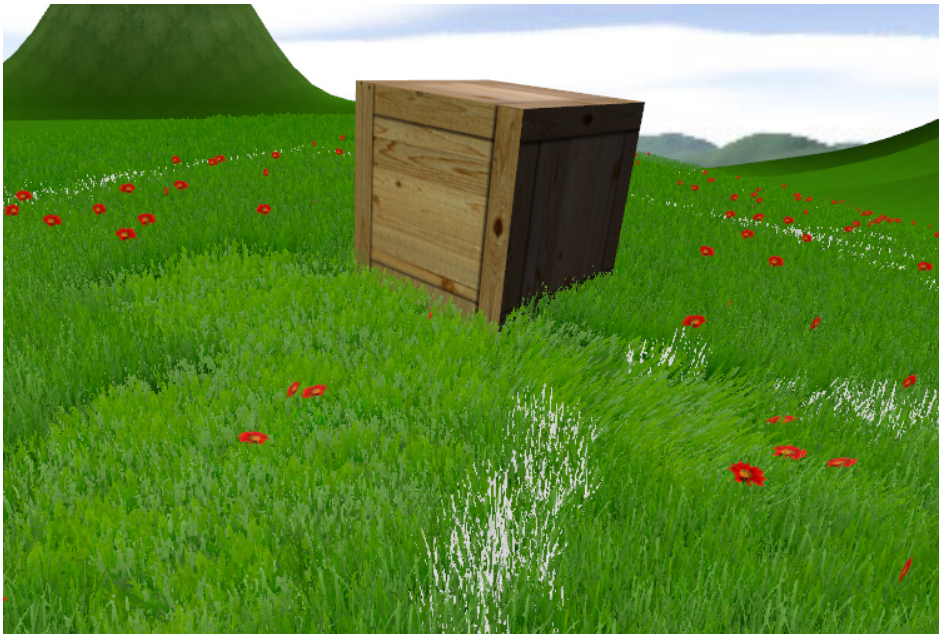
Abbildung 20: Kollisionsbehandlung von einem Starrkörper, der über die Wiese bewegt wurde
