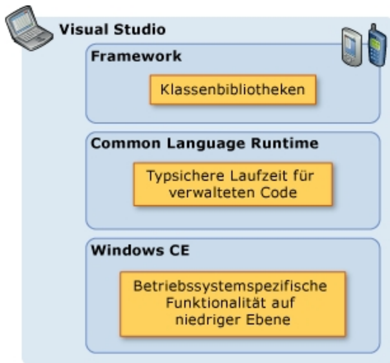
Abbildung 4.2: Architektur von .NET Compact Framework (Quelle: [Mic])
