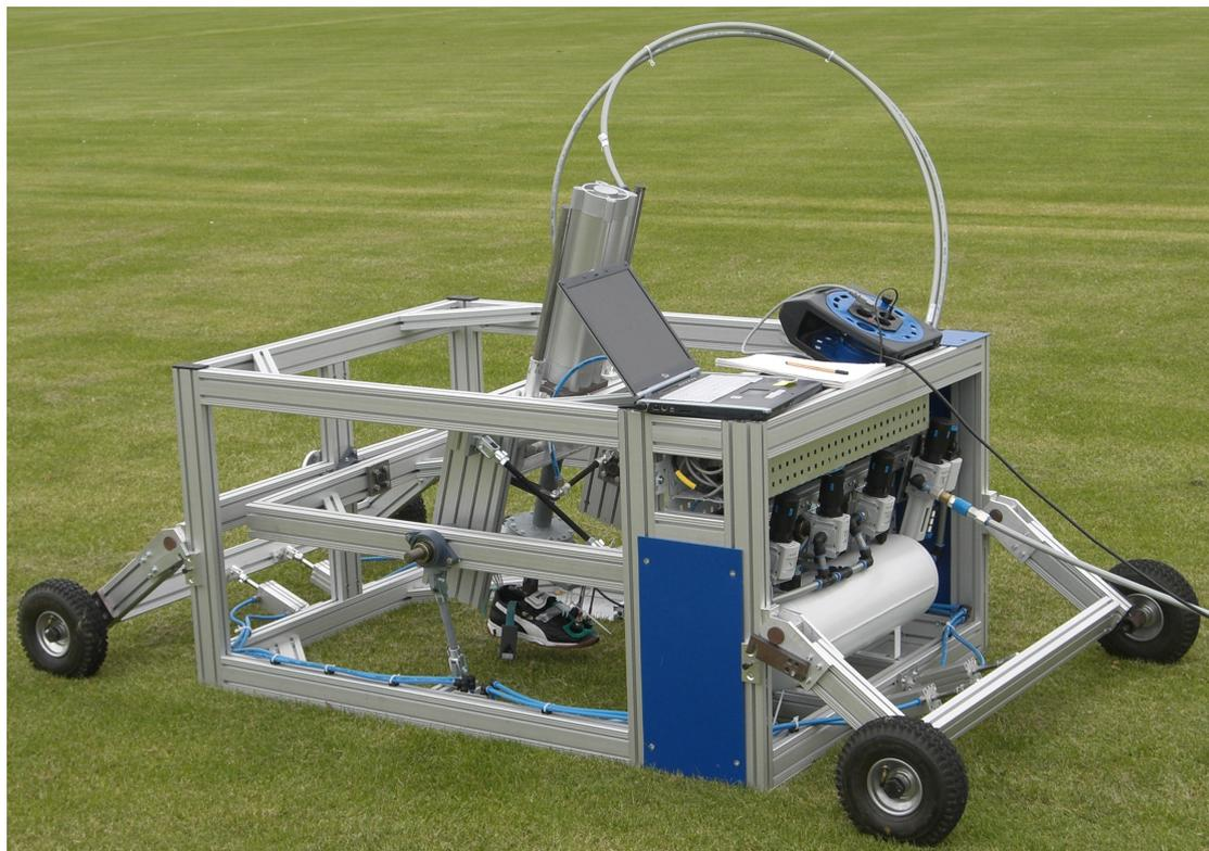
**Abb. 5.4:** Endversion des messbereiten Testgeräts TrakTester. Die Steuerung der Messzyklen und die Datenerfassung erfolgen über den Laptop. Der Hubmechanismus mit Rollen ermöglicht die leichte Versetzung während der Messungen.
