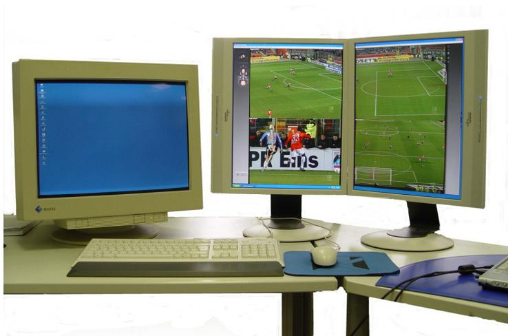
**Abb. 3.8:** PC-Arbeitsplatz für die Videobearbeitung und die Durchführung der Poser-Analyse. Die beiden rechten 20"-TFT-Monitore ermöglichen die gleichzeitige Darstellung von bis zu vier Kameraperspektiven in der Originalauflösung von bis zu 1024x768 Pixeln je Kameraeinstellung.
