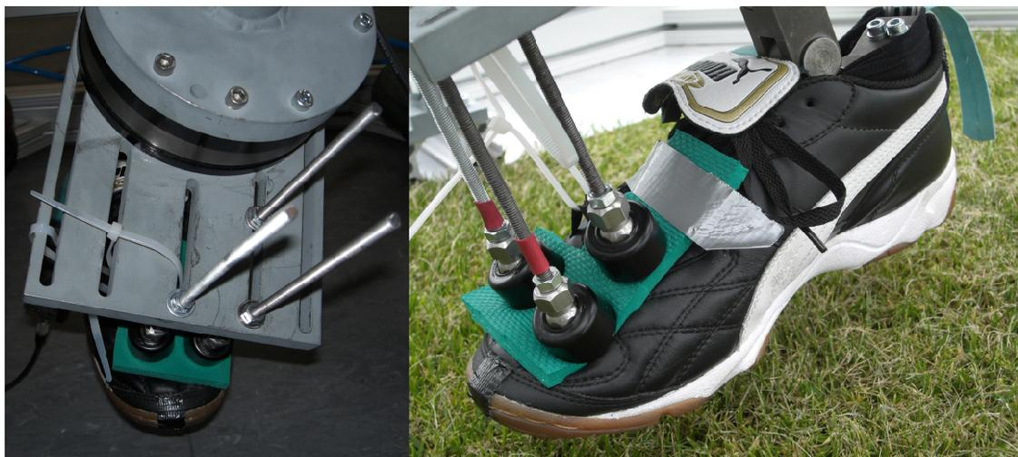
**Abb. 5.11:** TrakTester Details - plantare Druckverteilung.
