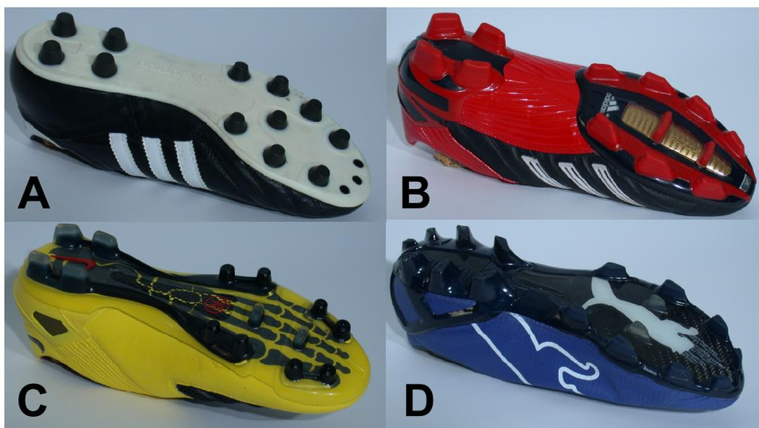
**Abb. 6.1:** Stollendesign der getesteten Fußballschuhe. Schuh A besitzt ein klassisches Stollendesign mit runden Stollen bzw. Nocken, Schuh B und Schuh D haben lammellen- bzw. ellipsenförmige Stollen und bei Schuh C sind runde und lamellenförmige Stollen gemischt angeordnet.
