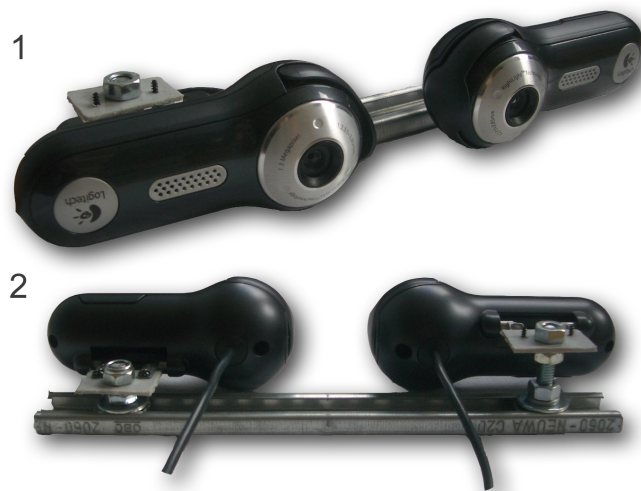
Abbildung 3.1: Befestigungsschiene zur festen Montage der Kameras, es sind jedoch Position und Winkel justierbar.
