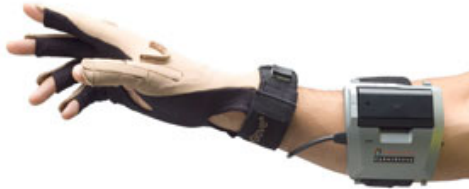
Abbildung 2.1: Datenhandschuh CyberGlove der Firma Immersion zur Dateneingabe, Quelle: http://www.immersion.com/3d , April 2006
