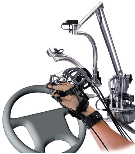
Abbildung 2.2: Interaktionshandschuh CyberForce mit Force-Feedback der Firma Immersion, Quelle: http://www.immersion.com/3d
