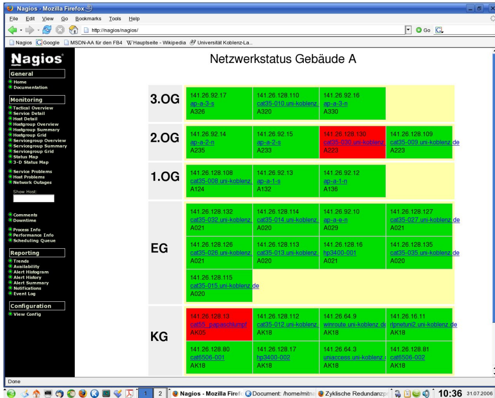
Abbildung 6.5: Darstellung der Switches, mit Zustand, im A-Gebäude des Campus Koblenz.
