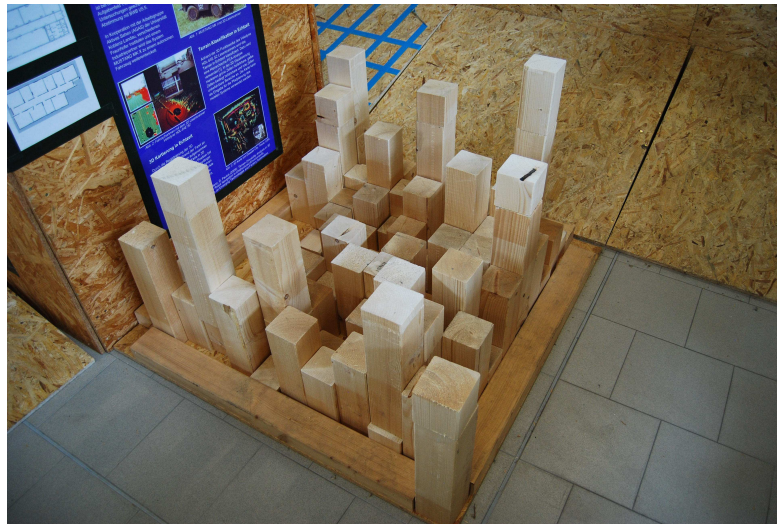
Abbildung 2.1: Ein stepfield , welches einen Geröllhaufen simulieren soll. Die unterschiedlich hohen Blöcke erschweren es dem Roboter zu beurteilen, ob es sich hier um ein nicht befahrbares Hindernis handelt.
