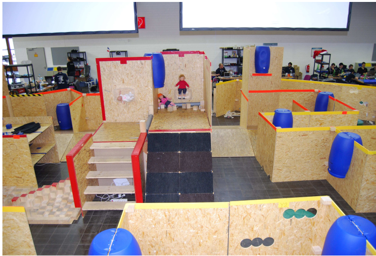
Abbildung 2.2: Überblick über einen Teil der Arena auf der RoboCup German Open 2011. Im Hintergrund sind 15° Rampen zu erkennen. Im vorderen linken Abschnitt befindet sich ein stepfield . Neben der Treppe, die in der Mitte der Arena zu erkennen ist, befindet sich eine 30° Rampe mit einer anschließenden zweiten Ebene, auf der sich zwei durch Puppen simulierte Opfer befinden. Die blauen Tonnen (sogenannte fiducials ), dienen der Qualitätsbewertung der erstellten Karte.
