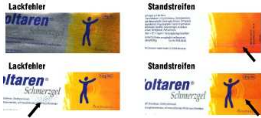
Abb. 5. Erkennen von Fehlern beim Verpackungsdruck
