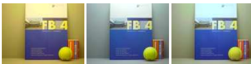
Abb. 3. Aufnahmen von der vierten Szene unter verschiedenen Bedingungen (Links: CWF-Beleuchtungsbedingungen; Mitte: Referenzbedingungen (D50); Rechts: Approximation)
