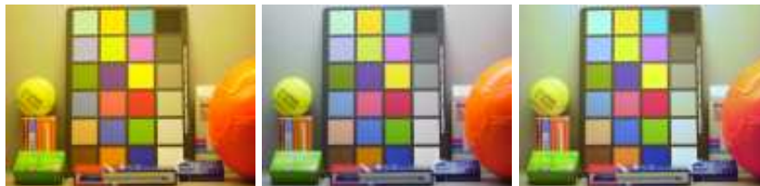
Abb. 2. Aufnahmen von der zweiten Szene unter verschiedenen Bedingungen (Links: CWF-Beleuchtungsbedingungen; Mitte: Referenzbedingungen (D50); Rechts: Approximation)
