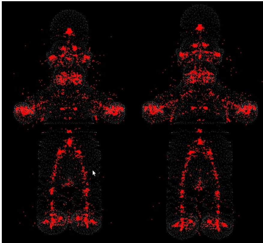
Abbildung 5.3: Normalenschnitte (rot) für nicht reduzierte Datensatz Homer mit \rho_c = 72 und \rho_e = 9 (Links) und \rho_e = 18 (Rechts)
