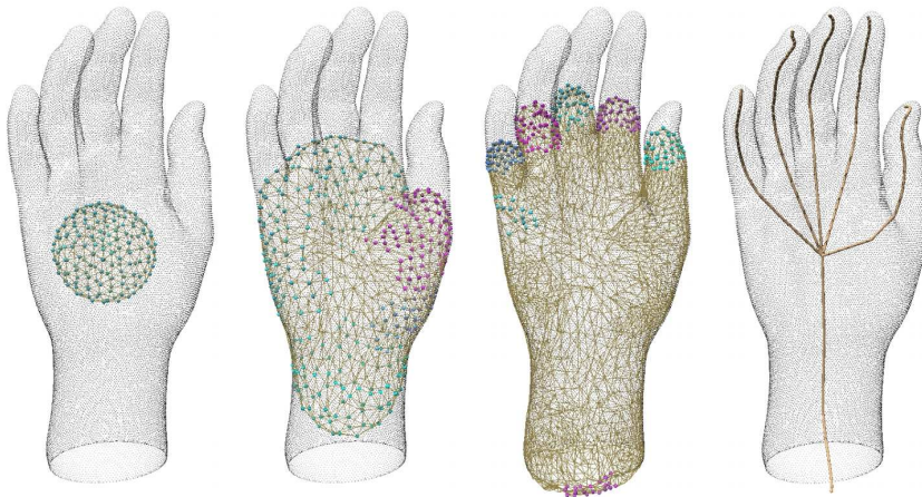
Abbildung 2.11: i = 0 - Deformable Modell DM als Sphäre im Objektzentrum; Teilung der Fronten in k Teilfronten GF_{i,k} ; Jede Teilfront expandiert weiter; Der erzeugte Skelettgraph des Objektes
