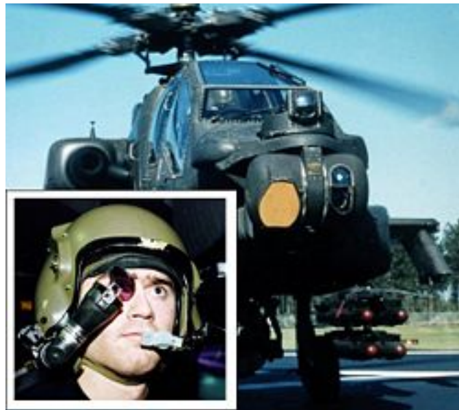
Abbildung 6: Pilot mit IHADSS und ein Apache AH-64 (Quelle: [Zor10])
