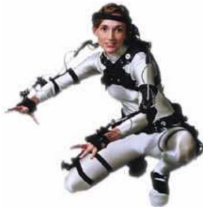
Abbildung 7: Ein elektromechanisches Exoskelett (Quelle:[Ul02])
