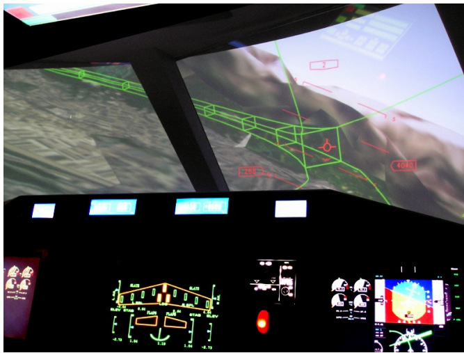
Abbildung 5: Flugsimulator mit Highway in the Sky und Predictor (Quelle: [Mad04])
