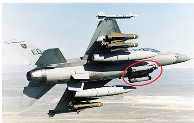
Abbildung 4: Ein F-16 Düsenjet mit LANTIRN (Quelle: [Zor10])
