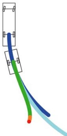
Abbildung 2.4: Aufsicht des Gespanns mit Gespanntrajektorie als hellblaue Fahrkurve.
