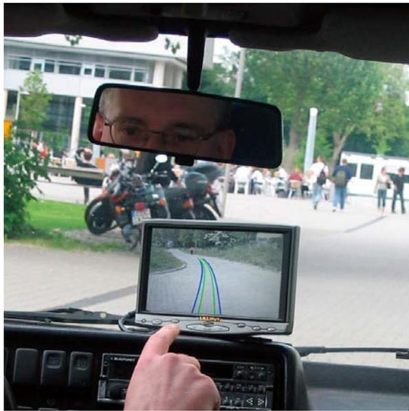
Abbildung 5.6: Einsatz des optischen Lenkassistentensystems im Versuchsfahrzeug.
