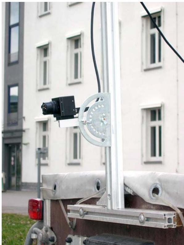
Abbildung 3.5: Kamerahalterung am Heck des Anhängers.
