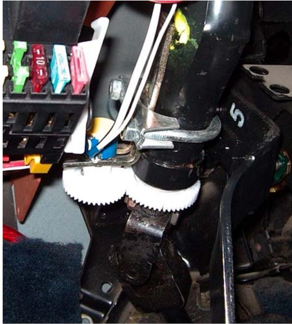
Abbildung 3.3: Potentiometer an der Lenksäule des Versuchsfahrzeugs.
