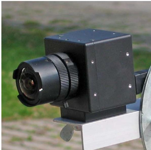
Abbildung 3.6: Firewire Kamera mit Weitwinkel-Objektiv.
