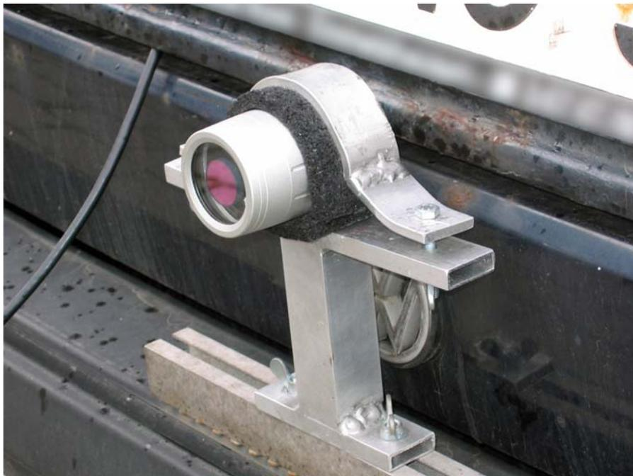
Abbildung 3.1: Infrarotkamera am Heck des Zugfahrzeugs
