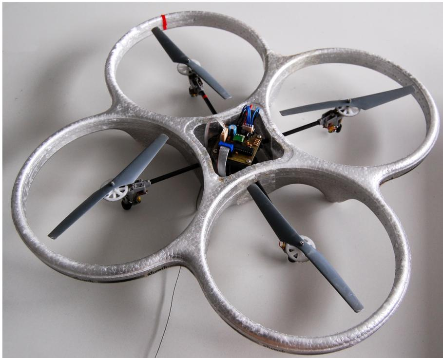
Abbildung 3.0.1.: Der Quadrocopter X-Ufo mit der entwickelten Steuerplatine zum Abschluss der Arbeit. Unter der Platine (im Bild nicht sichtbar) sind ein Fernsteuerungsempfänger und eine Wii MotionPlus befestigt.
