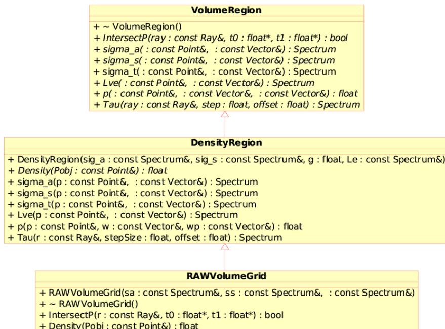
Abbildung 11: Die Klasse `RAWVolumeGrid` und seine Basisklassen.
