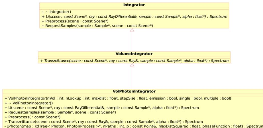
Abbildung 7: Die Klasse *VolPhotonIntegrator* und seine Basisklassen
