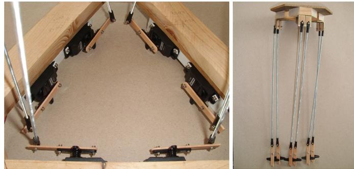
(a) Gesamtansicht der Motoren und (b) Der Aufsatz des Beine.
