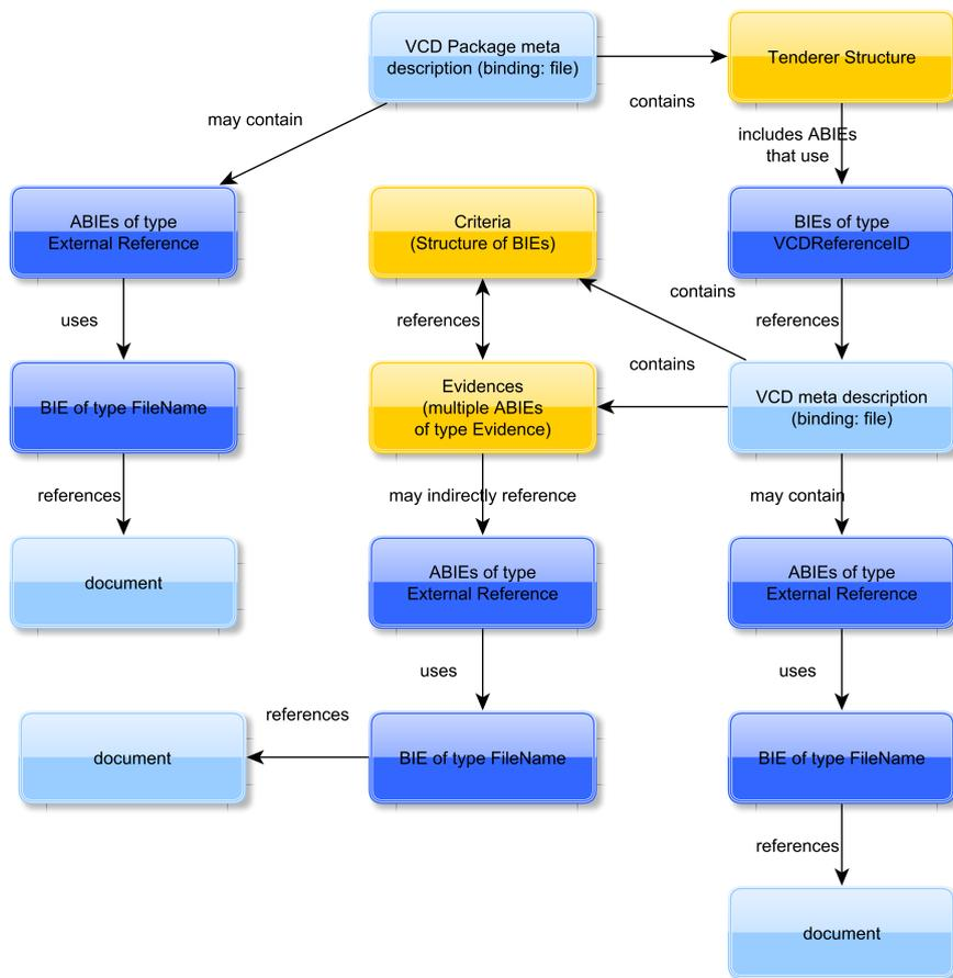
Abbildung 3.17: Zusammenhang der Datenmodelle (VCD-Package bzw. VCD)
