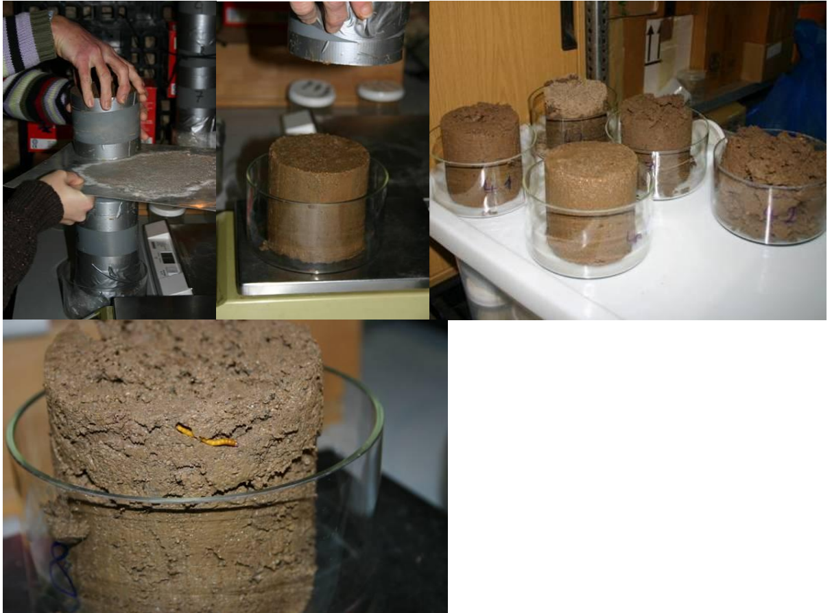
Abbildung 109: Verfahren der Zerteilung in die einzelnen Rohrsegmente (eigene Aufnahmen)
