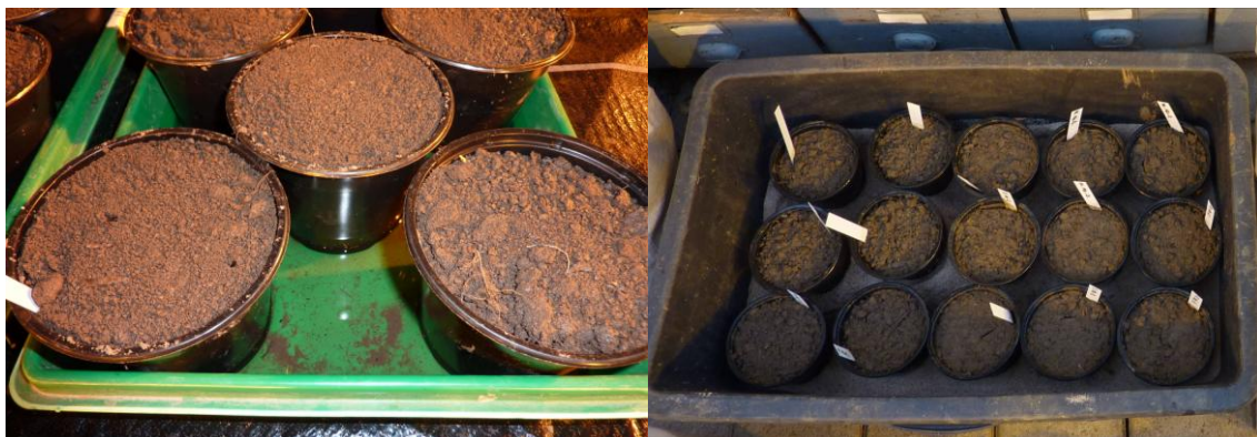
Abbildung 87: Aufsättigung der Bodentöpfe bis zur maximalen Wasserkapazität (links) und anschließende Entwässerung der überkapillaren Hohlräume (rechts)
