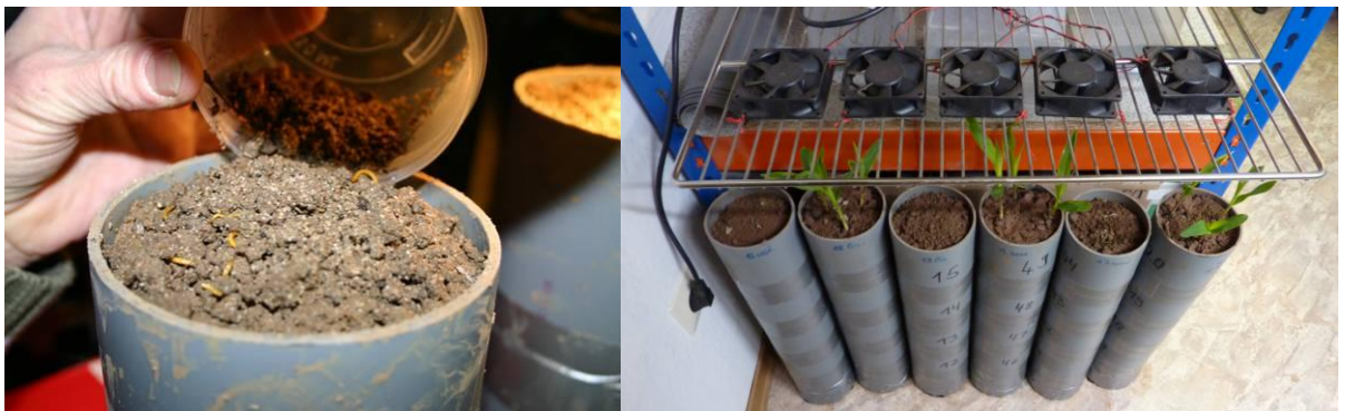
Abbildung 108: Einsetzen von 20 Drahtwürmern in die Bodenrohre (links) und Abtrocknung der Rohre zur Erzeugung eines Feuchtgradientens (rechts) (eigene Aufnahmen)
