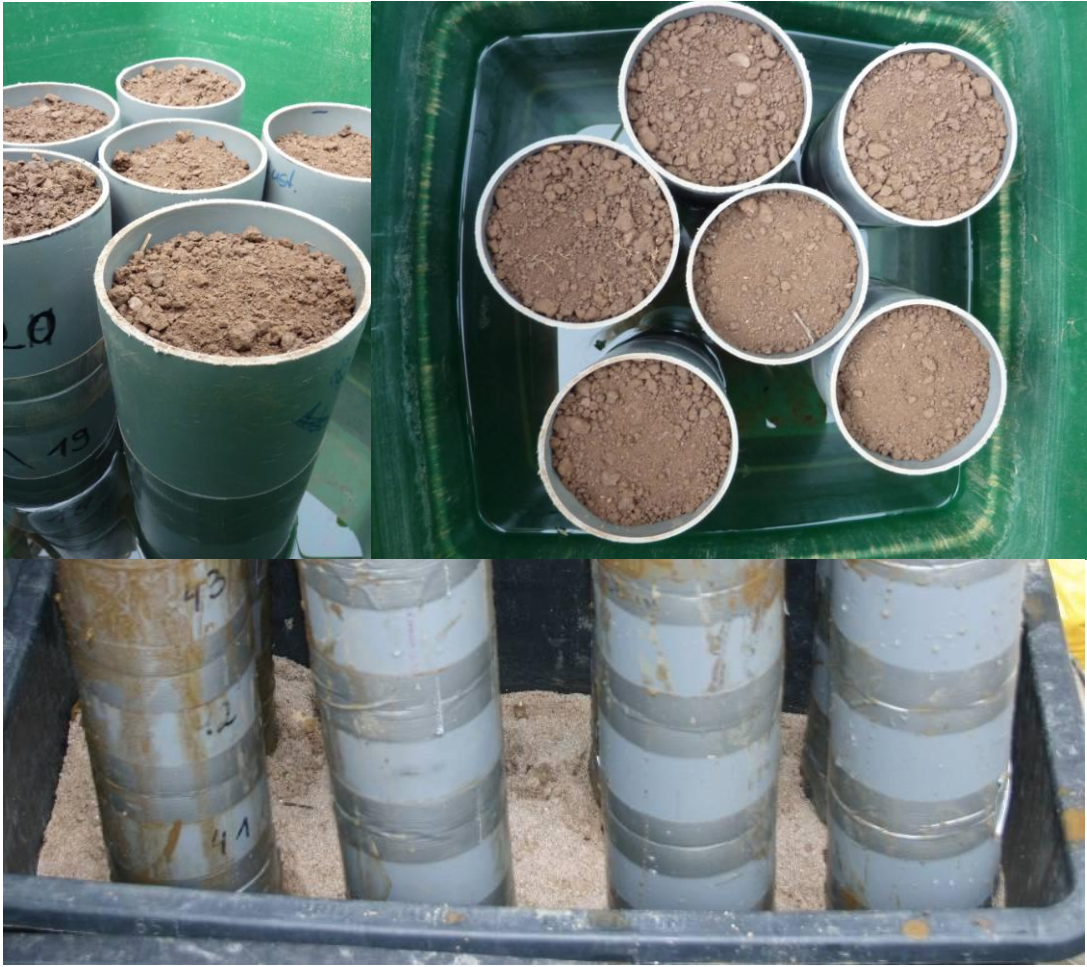
Abbildung 107: Sättigung der Bodensäulen bis zur maximalen Wasserkapazität (eigene Aufnahmen)
