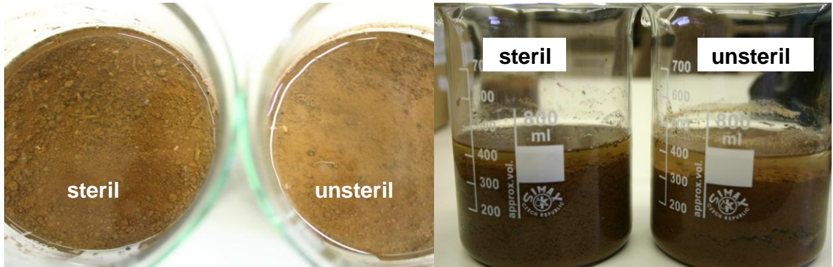
Abbildung 50: Bodenstruktur der sterilen (autoklavierten) und der unsterilen Variante der Bodenart schwach toniger Lehm nach Wasserzugabe des Versuches vom 19. Juli 2010 (eigene Aufnahme)
