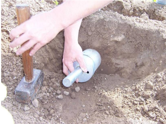
Abbildung 13: Entnahme einer Bodenprobe zur Kalibrierung der Theta-Sonde (eigene Aufnahme)
