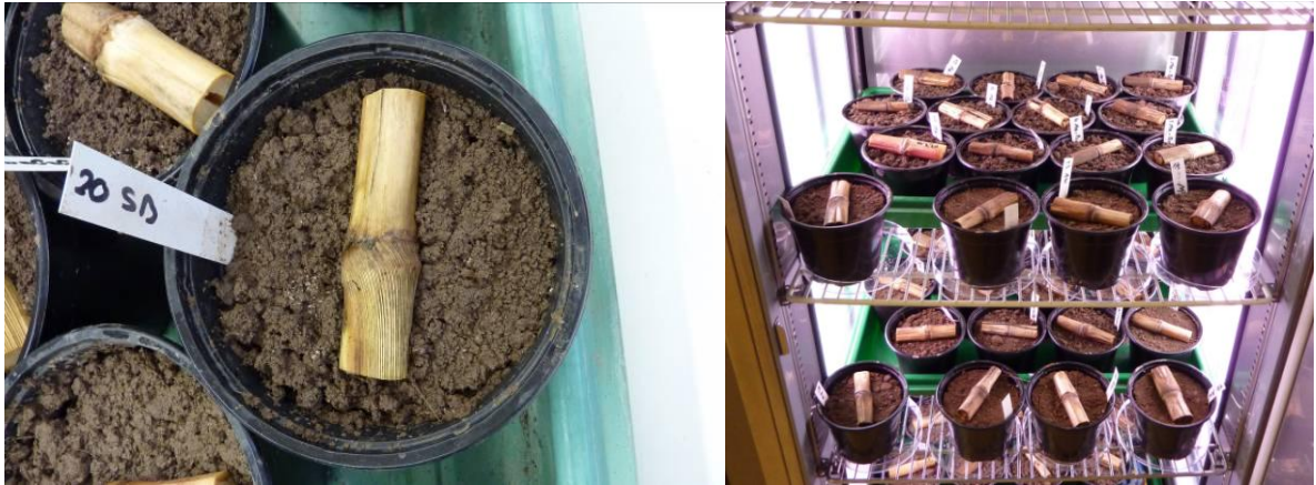
Abbildung 88: Aufbau der Versuche zum Einfluss der Bodenfeuchte auf die Maisstoppelabtrocknung
