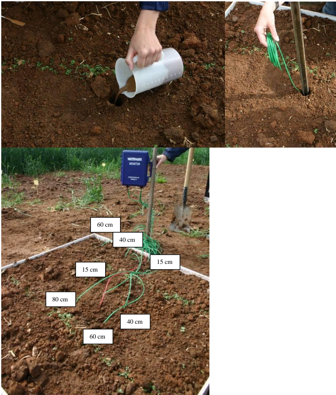
Abbildung 112: Einschlämmung der Watermarksensoren und Position der Sensoren innerhalb des Messkäfigs (eigene Aufnahmen)
