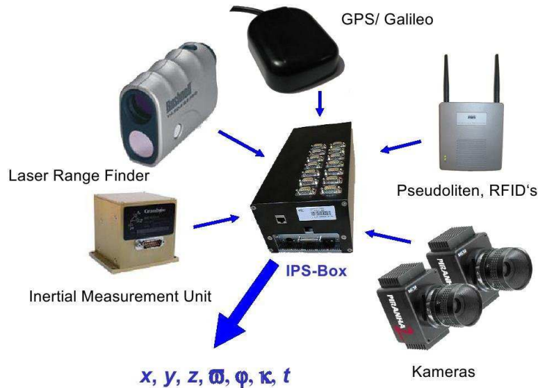
Bild 1.1: Ein möglicher multisensorieller Systemmessaufbau zur Bestimmung der gewünschten Parameter von Position (x, y, z) , Lage (\varpi, \varphi, \kappa) und Zeit (t)
