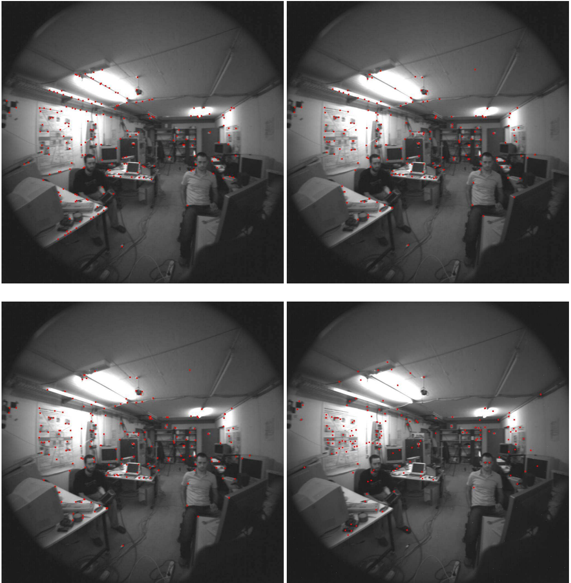
Bild 2.8: [v.l.n.r.,v.o.n.u.] Gegenüberstellung der jeweiligen Extraktoren mit den 200 stärksten Features. MORAVEC, KLT, HARRIS, SIFT
