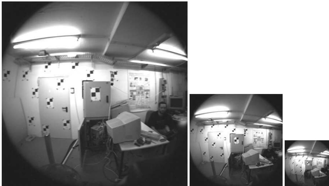
Bild 3.4: Die Pyramidenstufen des linken Stereobildes aus Abbildung 2.3 mit Auflösungsstufen von 512 \times 512 , 256 \times 256 und 128 \times 128 .
