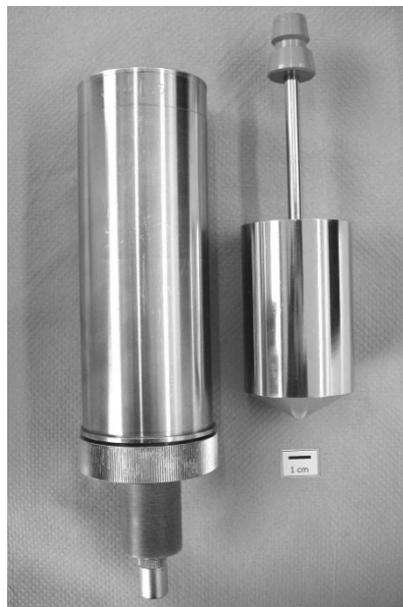
Abbildung 24: Koaxiales Zylinder-System (nach MK-DIN 145 von Lamy Rheology, Frankreich)
