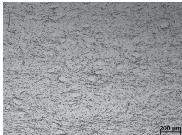
Abbildung 85: Lichtmikroskopische Aufnahme eines Gefüges einer RBAO-Probe, hergestellt aus in 4-Methyl-2-pentanol gemahlenem Pulver, Grünkörper mit 50 MPa uni-axial gepresst, bei 160 MPa kaltisostatisch nachverdichtet, gesintert für 2 h bei 1600 °C
