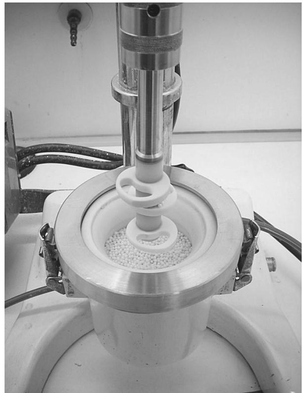
**Abbildung 18: Detailansicht der betriebsbereiten Mühle mit eingesetzter Rührwelle und eingespanntem Mahlbehälter gefüllt mit Mahlperlen**
