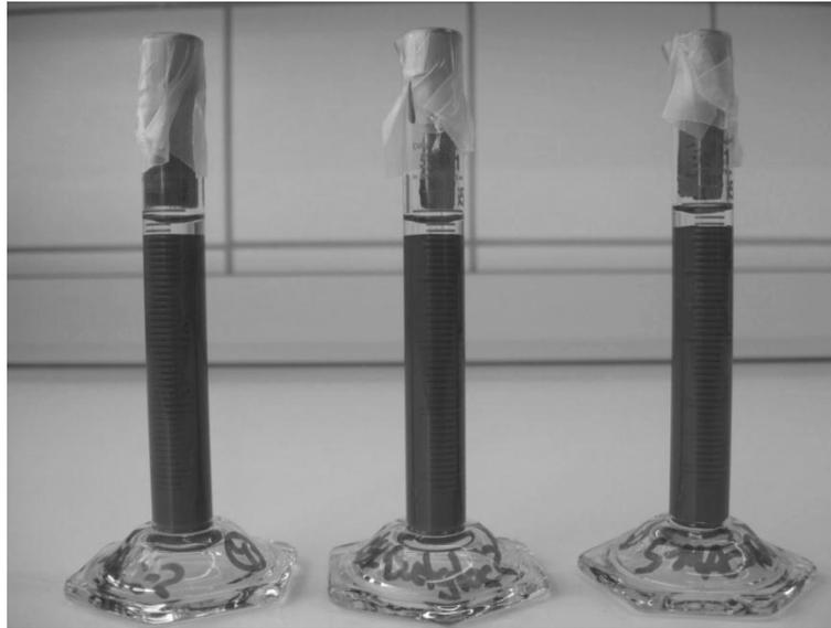
**Abbildung 25: Standzylinder zur Bestimmung von Sedimentationsverhalten und Sedimentvolumen, am Beispiel einer Mahlung in Butylethanoat im Cr-Al<sub>2</sub>O<sub>3</sub>-System [97]**
