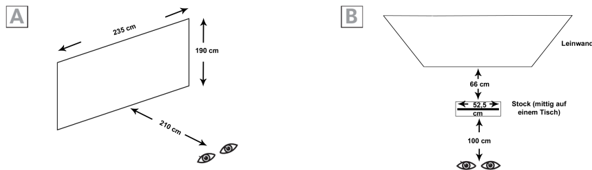
Abbildung 8: Versuchsaufbau mit Maßangaben zu Abständen sowie Größe der Leinwand
