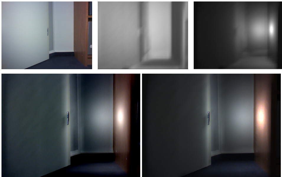
Abbildung 18: Beleuchtungsszenario 1: Ersetzen einer Lichtquelle. Oben links: Ausgangsbild. Oben mitte: Beleuchtungssimulation der Lichtverhältnisse. Oben rechts: gewünschte Beleuchtungssimulation . Unten links: Ergebnis Verfahren 1. Unten rechts: Ergebnis Verfahren 2.
