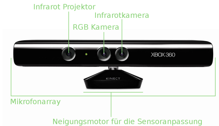
Abbildung 1: Aufbau des Kinect-Sensors[Com]
