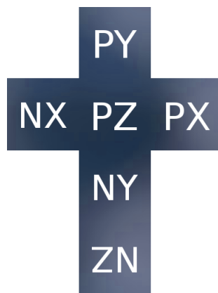
Abbildung 4: Aufbau eine Cube Map im Vertical Cross Format
