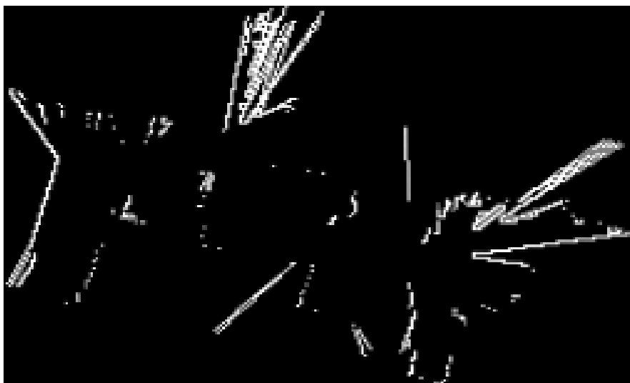
Abbildung 5.5: Extrahierte Grenzen in einem Binärbild visualisiert. Dient zur Weiterverarbeitung der Daten.
