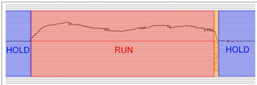
Abbildung 6.2: Zustände im Zeit-Distanz-Diagramm
