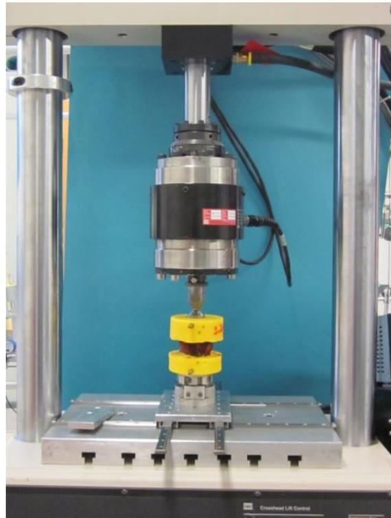
**Abb. 4.4: Bewegungssegment L2-L3 in der Materialprüfmaschine.**
