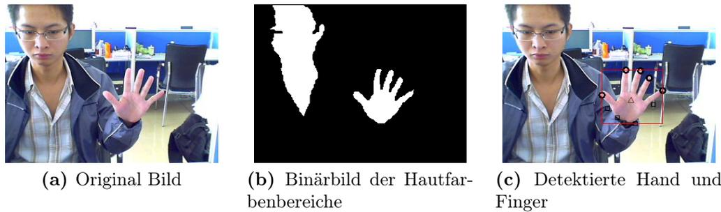
**Abbildung 2.31:** Bestimmung der Hand unter Verwendung der Hautfarbendetektion [WZ09].
