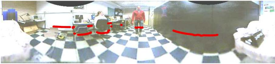
**Abbildung 2.27:** 2D-Laserscanner in Kombination mit einer omnidirektionalen Kamera [ZK07]
