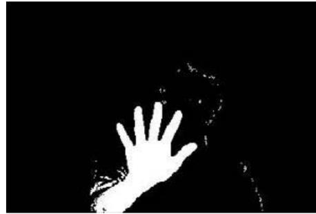
(b) Separieren der Hand mit Hilfe der Entfernung zur Kamera
