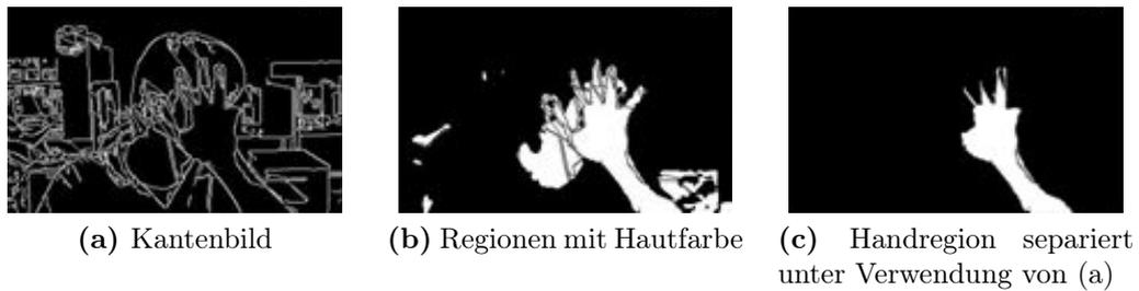
**Abbildung 2.35:** Extraktion der Hand und dem Unterarm aus [CSP09].
