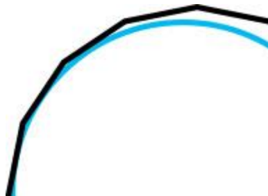
Abb. 7: eine zu hohe Schrittweite (schwarz) kann schnell zu Abweichungen von der realen Bahn (blau) führen
