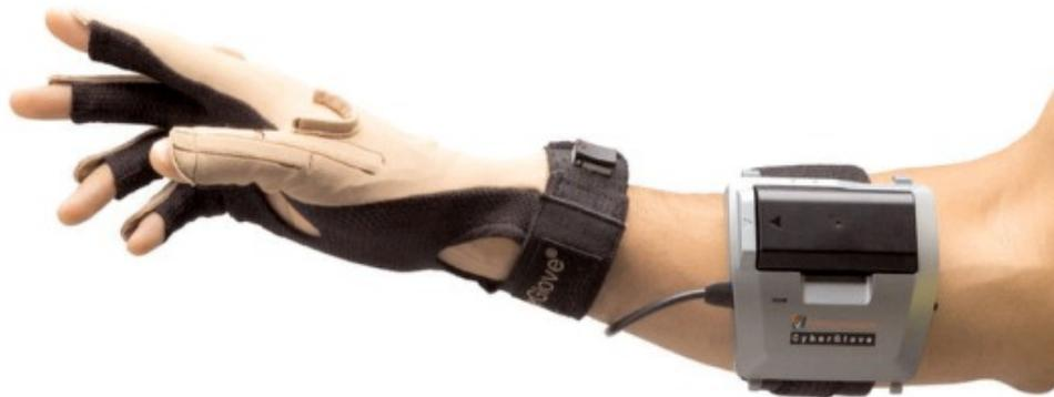
**Abbildung 2.16:** Der Datenhandschuh CyberGlove II (Bild verfügbar unter [Vir])
