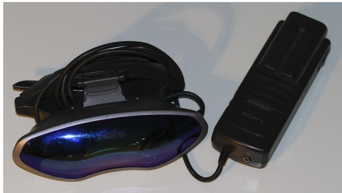
**Abbildung 4.3:** Die Videobrille Sony Glasstron PLM-A55
