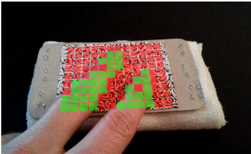
**Abbildung 5.10:** Image Target mit visuellen Überlagerungen entsprechend dem definierten Raster aus Virtual Buttons und deren Status, verdeckte Virtual Buttons werden grün angezeigt, nicht verdeckte rot
