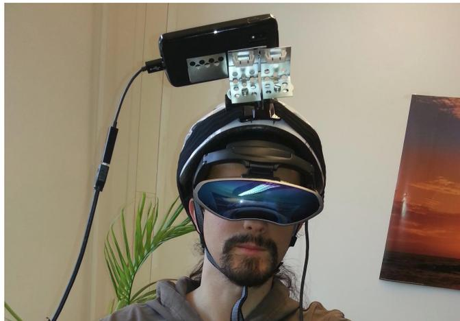
**Abbildung 4.2:** Konstruktion eines AR-Systems mittels Smartphone und AR-Brille
