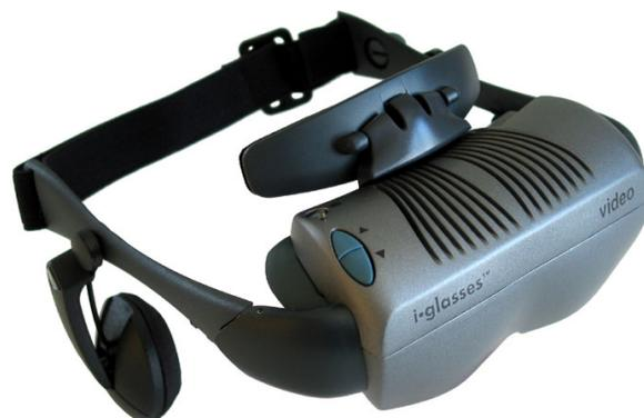
**Abbildung 2.4:** i-Glasses High Resolution Head Mounted Display (siehe [Sew09])
