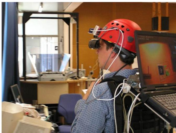
**Abbildung 4.1:** Konstruktion eines AR-Systems mittels Notebook, Rucksack, AR-Brille und Webcam (siehe [Ins])
