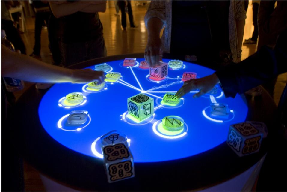
**Abbildung 2.15:** Reactable – ein Tangible User-Interface (Bild verfügbar unter [Wik13b])
