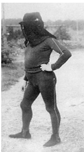
Abbildung 2.11. Marey's Anzug zur Bewegungsanalyse. [www:Marey]
