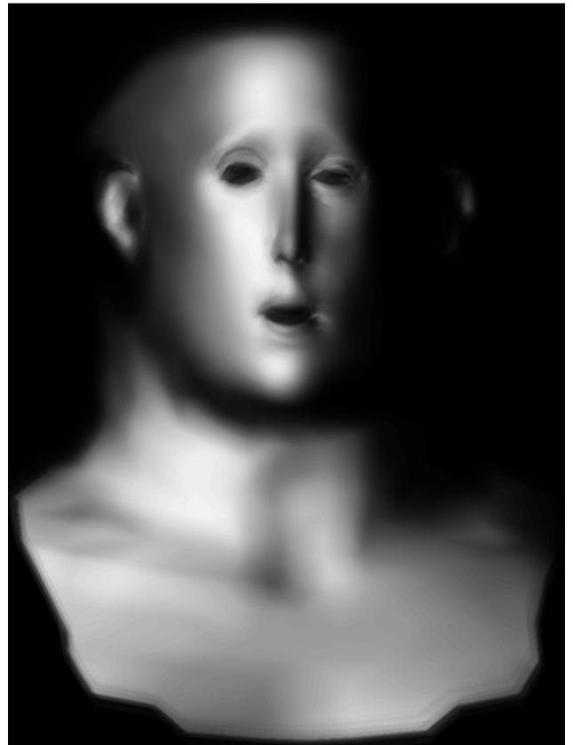
Abbildung 4.5: In der zweiten Phase wird die Textur mit Scattering gefiltert (hier: 4 Durchläufe)
