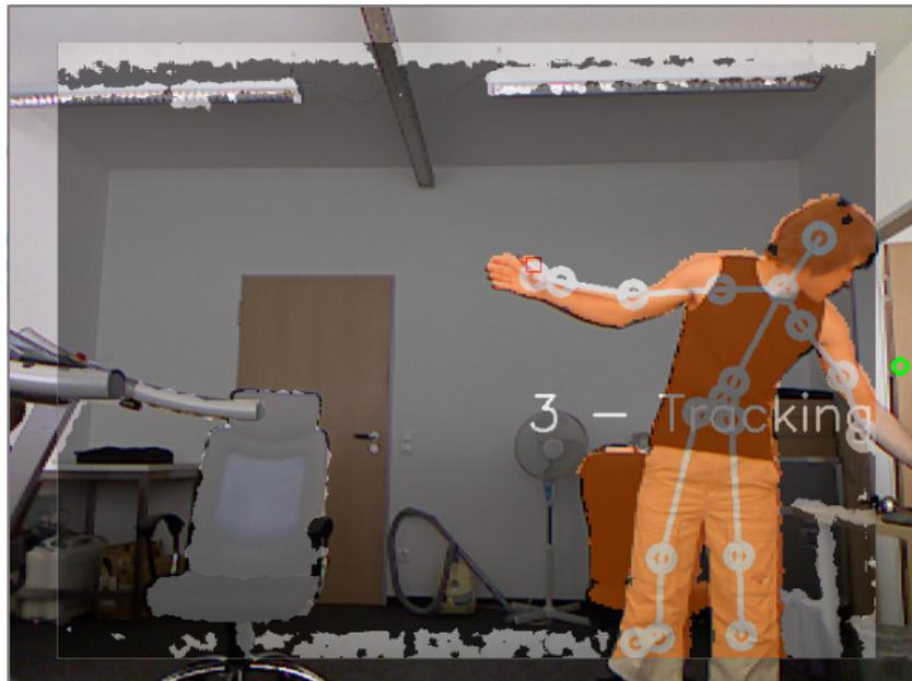
**Abbildung 4.1:** Tiefenbild der Kinect auf deren Farbbild projiziert
