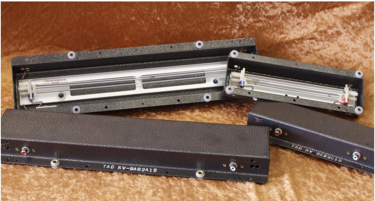
*Abb. 2: Federhallmodule von Tube Amp Doctor. Die Anschlussbuchsen an der Gehäusesseite sind einfache RCA-Buchsen, wie sie an Stereoanlagen Verwendung finden - Trotzdem benötigen sie Vor- und Nachverstärkung, was meist zu deutlichem Grundrauschen führt.*
