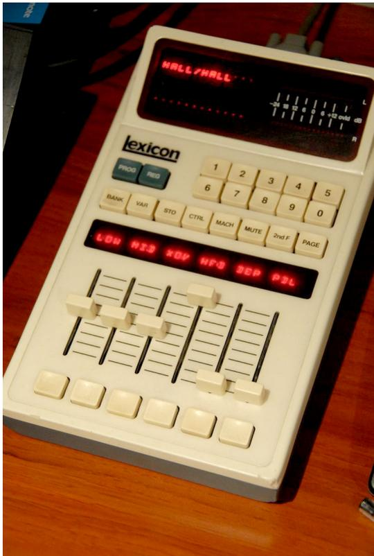
Abb. 4: Der Lexicon 224 XL, einer der ersten digitalen Halleffekte. Das Bild zeigt nur die Bedienung, die eigentliche Hardware ist in einem großen 19 Zoll-Gehäuse untergebracht. Viele der preiswerteren frühen digitalen Halleffekte wiesen künstlichen Klang oder deutliche digitale Artefakte und Grundrauschen auf. Heutzutage liefern jedoch auch preiswerte, viel kompaktere Modelle oder Softwarelösungen sehr natürliche und vielseitige Ergebnisse.
