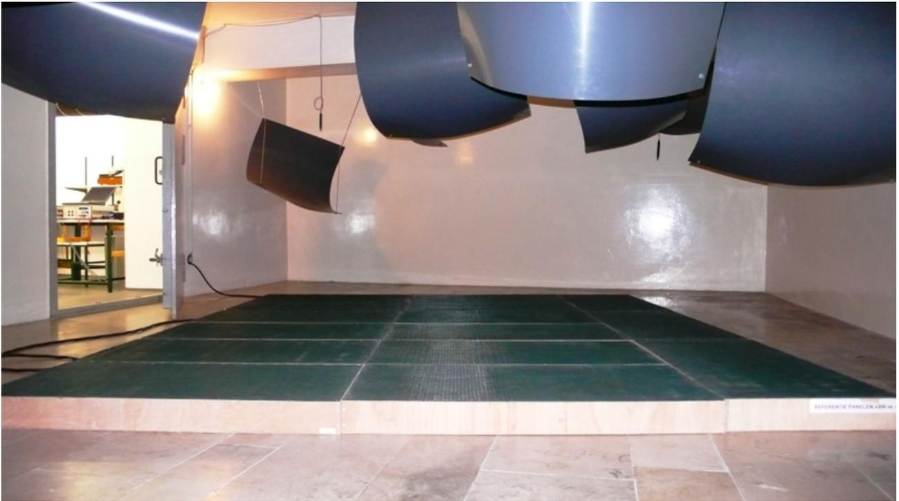
*Abb. 1: Speziell präparierter Hallraum. Die aufgehängenen Plexiglasplatten erweitern die Geometrie des Raums, sodass besonders viele Moden entstehen und komplexerer Nachhall auftritt.*
