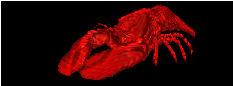
Abbildung 25: Typische Artefakte bei einer zu niedrigen Abtastrate eines Volumens [6].
