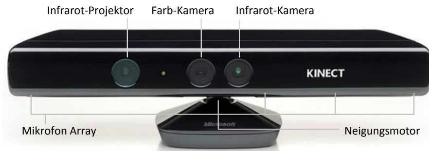
Abbildung 1: Aufbau des Kinect-Sensors [uWB]
