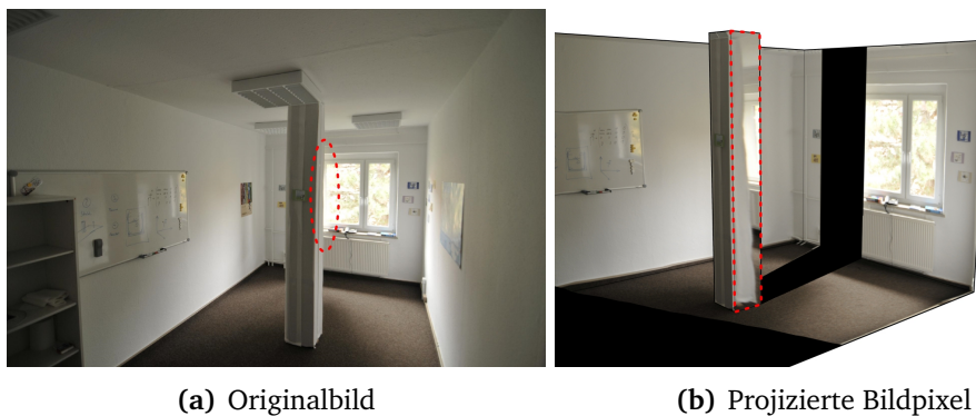
Abbildung 4.35: Fehlerhafte Rekonstruktion von Strahldichten auf Grund falsch projizierter Bildpixel an Bereichen mit großen Tiefenunterschieden im Bildraum
