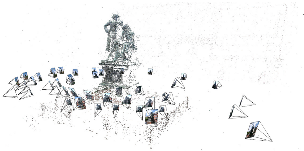
Abbildung 1.1: Eine 3D-Photo-Collection besteht aus Bildern mit bekannten Kameraposen sowie einer 3D-Punktwolke, welche eine grobe Rekonstruktion der Szenengeometrie darstellt.
