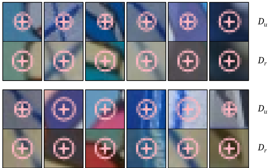
Abbildung 3.6: Berechnete Radien der Kreisausschnitte für beide Bildpaare wählen in guter Näherung korrespondierende Regionen auf der realen Oberfläche aus
