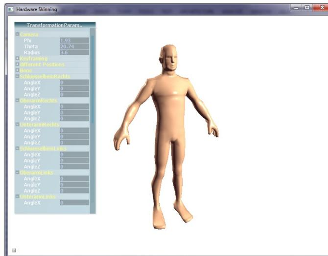
**Abbildung 8:** Beispiel eines Fensters der implementierten Anwendung. Neben dem Modell ist ein Widget eingefügt, über das man die Kameraposition auslesen und ändern kann. Die Rotationswinkel sind pro Bone einstellbar. Außerdem lässt sich eine Keyframing-Animation starten und die einzelnen Instanzen können beim Instancing in verschiedenen Positionen dargestellt werden.
