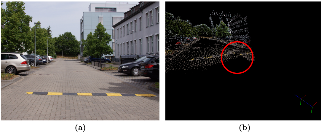
Abbildung 3.8: Bild 3.8a zeigt eines der beiden Ausgangsbilder, die für die Rekonstruktion des Modells, das in Bild 3.8b zu sehen ist verwendet wurde. In der rot eingekreisten Stelle ist ein deutlicher Versatz in der Bremschwelle zu sehen. Der Versatz ist Aufgrund der geringen Basislinie zwischen den beiden Kameras unten rechts im Bild entstanden.
