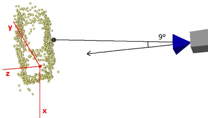
**Abbildung 28:** Filterung der Merkmale anhand des Blickvektors der Kamera. Es wird der Winkel zwischen dem Blickvektor und dem Vektor, der sich von Kamera zum entsprechenden Merkmal aufspannt, berechnet. Ist dieser größer als ein Schwellwert, wird das Merkmal verworfen.
