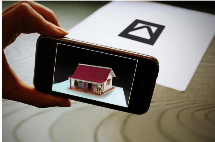
**Abbildung 3:** Markertracking in der Verwendung. Im Hintergrund ist ein Marker zu sehen, im Vordergrund wird das Kamerabild mit der virtuellen Welt überlagert. [6]
