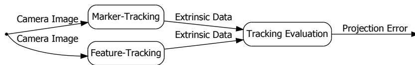
**Abbildung 24:** Pipeline zur Evaluation eines Tracking-Algorithmus. Als Eingabe erhalten beide Tracking-Actions ein Kamerabild. Daraus berechnen beide die extrinsischen Kameraparameter, sprich die Position der Kamera in Relation zum Referenzobjekt. In der `TrackingEvaluation`-Action werden diese beiden Positionen miteinander verglichen und darauf die Abweichung des Merkmal-Trackings im Vergleich zum Marker-Tracking berechnet.
