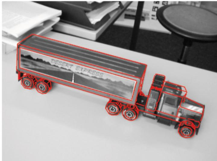
**Abbildung 4:** Kanten- und modellbasiertes Tracking. Das im Kamerabild zu sehende Fahrzeug wird mit seinem CAD-Modell perspektivisch korrekt überlagert. [32]
