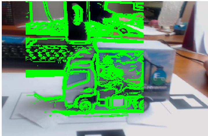
**Abbildung 16:** Überlagerung des Kamerabildes mit dem dazu am besten passenden DOT-Template. Das Template ist grün eingezeichnet an der Position, wo es dem Kamerabild am meisten gleicht.
