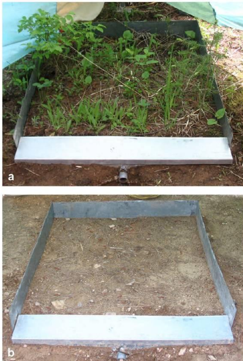
Abb. 5.18: Sedimentationsplot der KBA des USFS AWAE Programms. Abgebildet ist der Einsatz auf a) bewachsener und b) unbewachsener Wegoberfläche (Foltz et al. 2009, 2544).
