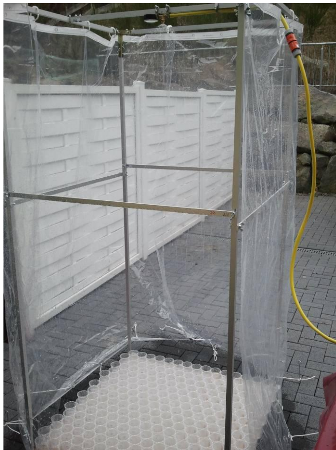
Abb. 5.20: Aufbau der KBA-Kalibrierung mit Niederschlagskollektoren.
