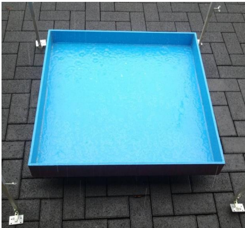
Abb. 5.22: Großkollektor zur Intensitätsmessung der KBA.
