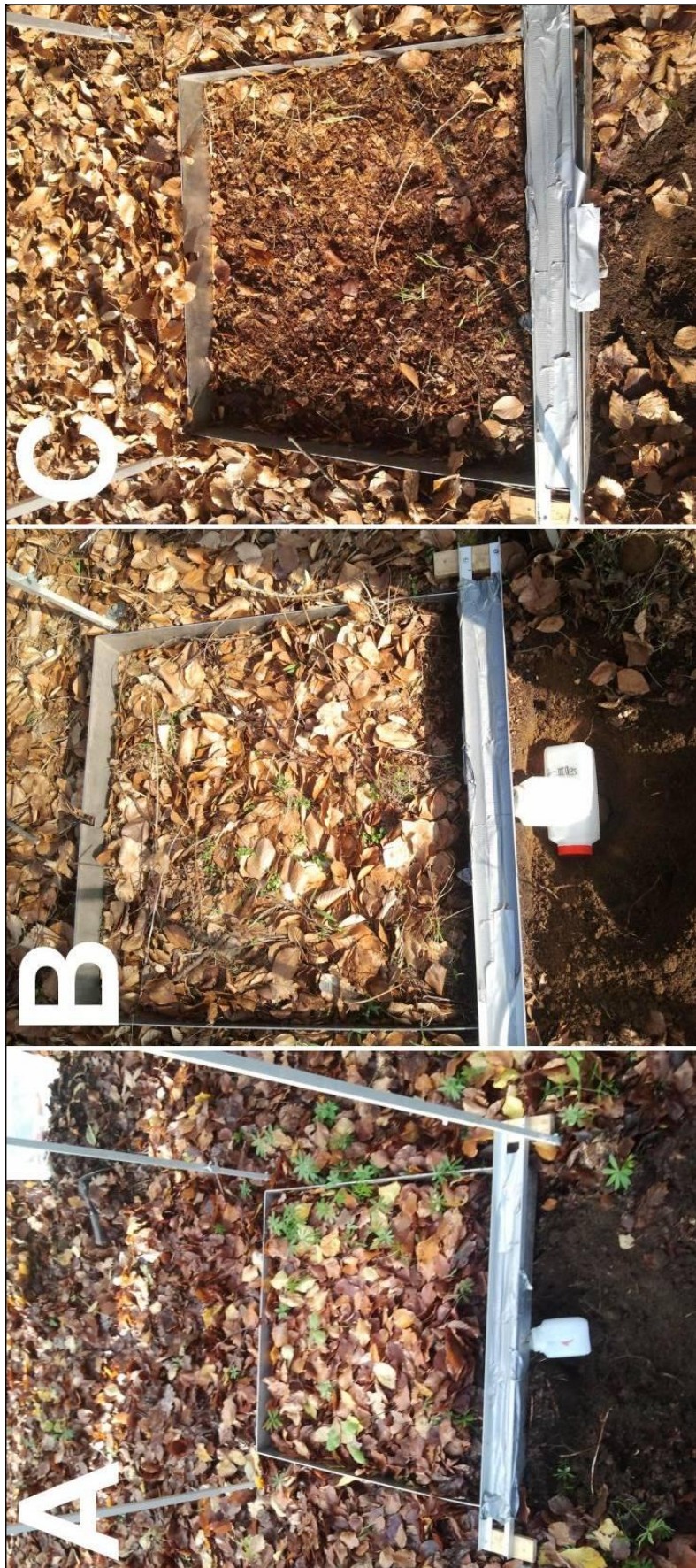
Abb. 6.104: Untersuchungsflächen der Beregnungsversuche auf Waldböden vor Beginn der Beregnung. (A) Versuch W1, (B) Versuch W2, (C) Versuch W3.
