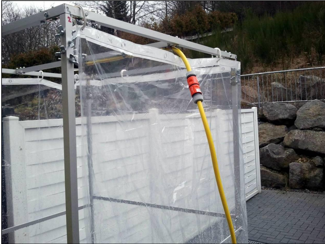
Abb 5.15: Vollständig mit Windschutz ausgerüstete KBA und Verschraubung des Kopfteils an den Standbeinen.
