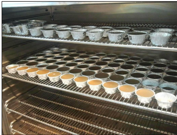
Abb. 5.29: Sedimentproben vor Beginn der Trocknungsphase.
