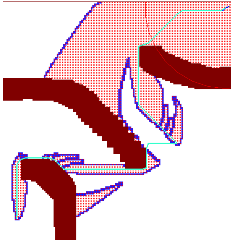
Abbildung 2.12: D* Lite Beispiel (blau: OpenList , braun: Hindernisse, hellblau: zurückgelegter Weg, rot: bearbeitete Knoten)
