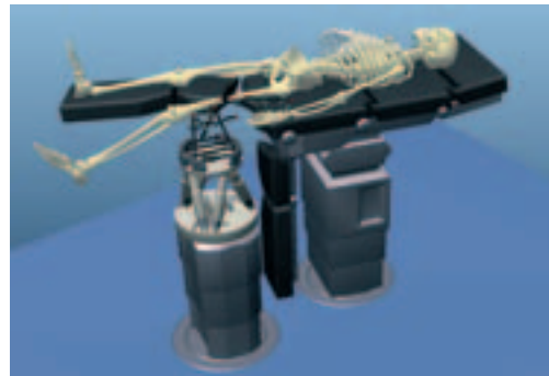
Exakte Positionierung der Bruchstücke durch OP-Tisch mit Hexapod.
